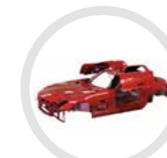
Mercedes-Benz SLS AMG Aluminiumkarosserie (2009 – 2014)
