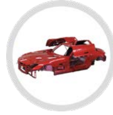
Mercedes-Benz SLS AMG Aluminiumkarosserie (2009 – 2014)
